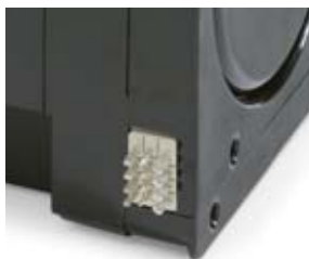
E Connettore CINCH (maschio montato sull'Hopper)
