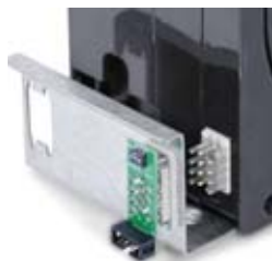
E1 Interfaccia MH455 con connettore 10 PIN.
