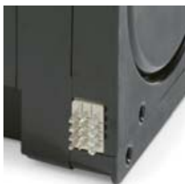
A Connettore CINCH (maschio montato sull'Hopper)
