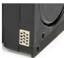
D Connettore CINCH (femmina montata sull'HOPPER)
